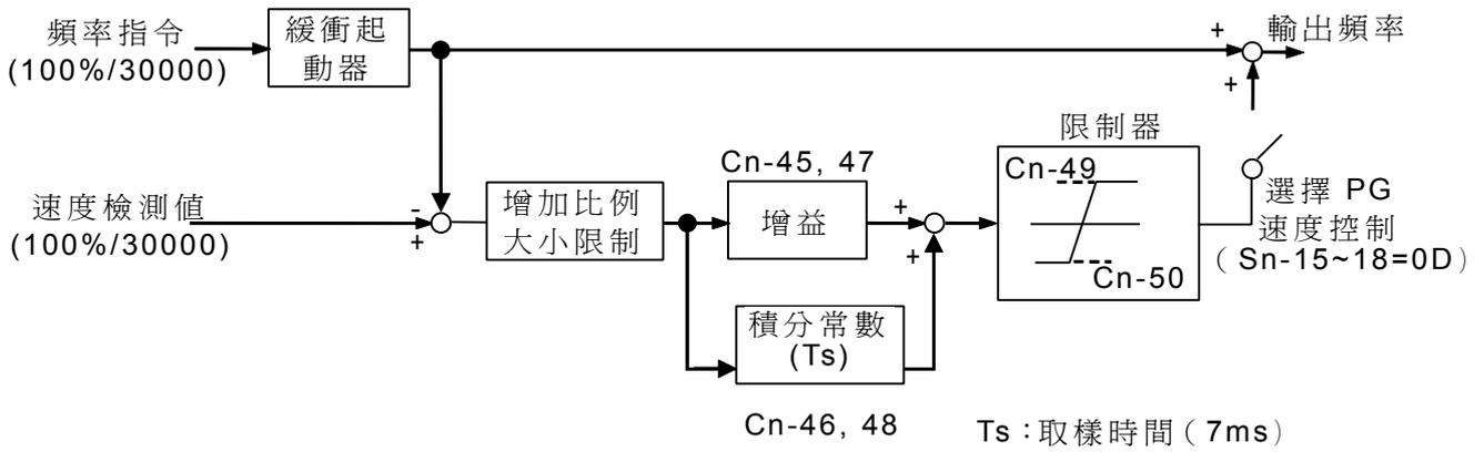
圖 15 PG 速度控制方塊圖
