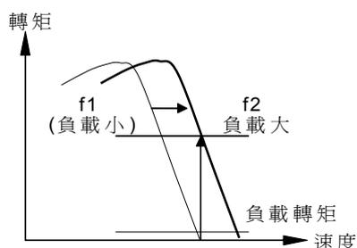
無速度檢出器(PG 或 TG)時，利用滑差補正機能，可作簡易速度控制。由於滑差補正機能，使頻率由 f1→f2，以減少因負載變動變動造成的速度變動。
