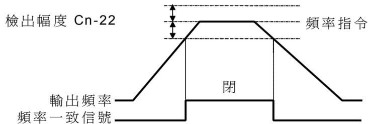
$$(\text{頻率指令} - \text{Cn-22}) \leq \text{輸出頻率} \leq (\text{頻率指令} + \text{Cn-22})$$
