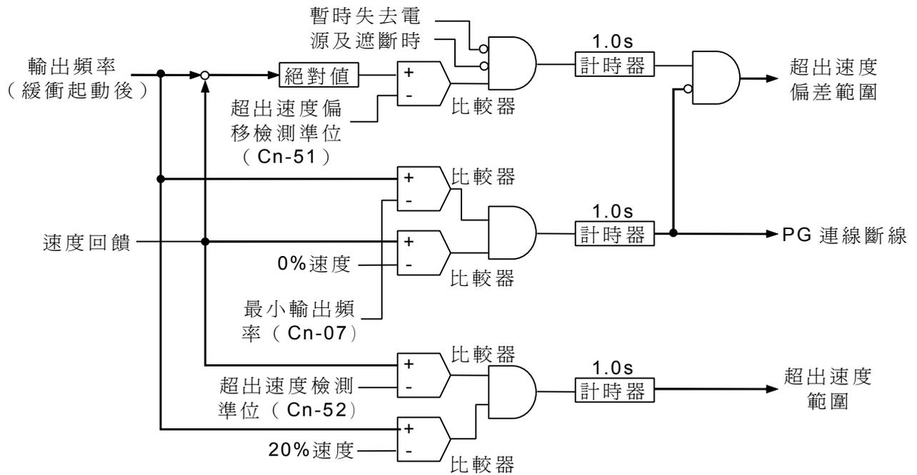
圖 16 PG 回授故障檢測方塊圖
