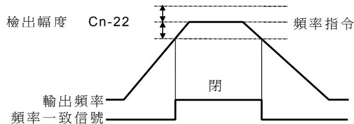
$(\text{頻率指令} - \text{Cn-22}) \leq \text{輸出頻率} \leq (\text{頻率指令} + \text{Cn-22})$
