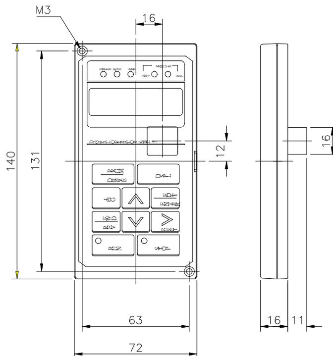
圖 6 LCD 數位操作器外形尺寸圖
