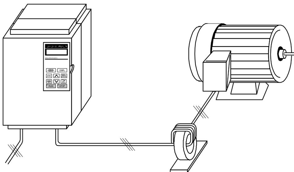
【註】：U, V, W 三條線需貫穿同一個 ZERO CORE，依同方向捲繞才有效果。
