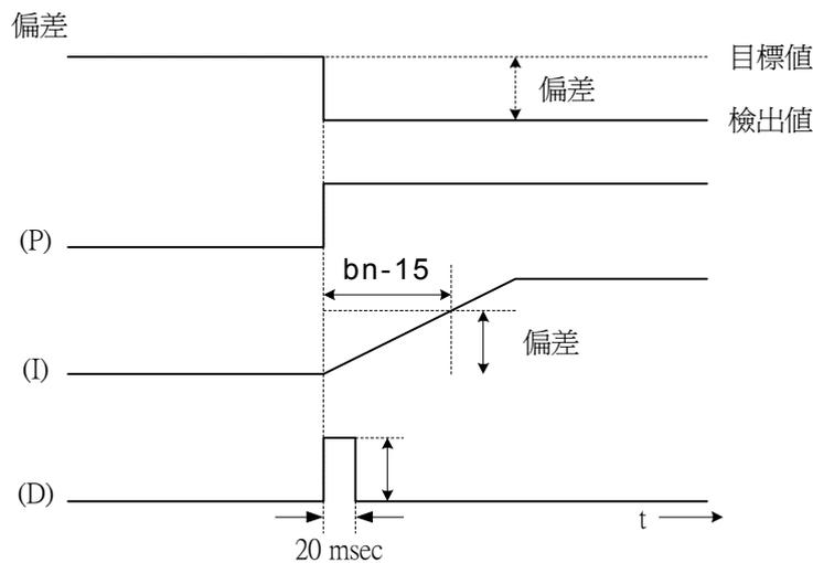
圖 13 PID 控制 step 偏差之響應例
